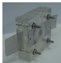
RAJAH 3. Sistem tunggal DMFC
